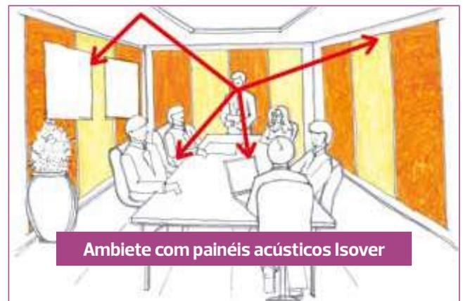
Os painéis acústicos Sonare, apresentam excelentes índices de absorção, proporcionando uma redução de energia das ondas sonoras, evitando seu retorno ao ambiente
