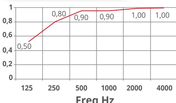
\*GRÁFICO CONFORME NORMA DIN EN ISO 354
