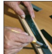
2 - Aplicar uma camada de cola de contato na fita de borda. A camada de cola deve ser bem distribuída e fina.
