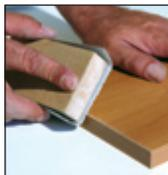
8 - Acabamento final com lixa 220. Lembrando que a posição deve ser sempre na diagonal para não machucar a fita nem a chapa.
