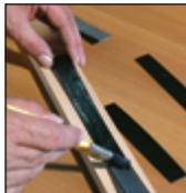
2 - Aplicar uma camada de cola de contato na fita da borda. A camada de cola deve ser bem distribuída e fina.
