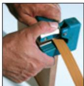
5 - Destopar a fita. Pode ser utilizado um destopador manual, estilete ou serra para cortar o excesso da fita.
