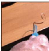
6 - Refilar a fita utilizando um estilete ou uma lima.
