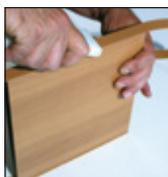
4 - Esfregar a fita para aderência. Pode ser utilizado um estregador de nylon ou madeira envernizada para não danificar a superfície da fita.
