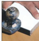
7 - Para refilar a fita, utilizar uma plaina manual, sem muita pressão para não agredir a placa. É indicado o uso da plaina na diagonal, para arredondar a fita.
